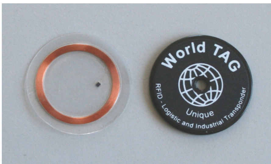
Bild 1: RFID-Tags: Elektronik (links) und Gehäuse (rechts)
